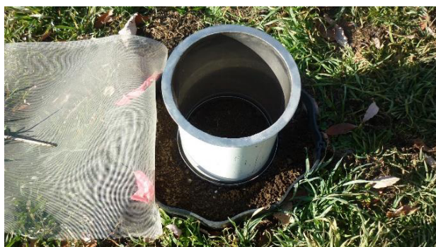
図6 裸地に設置されたチャンバーによる微生物呼吸量の測定
