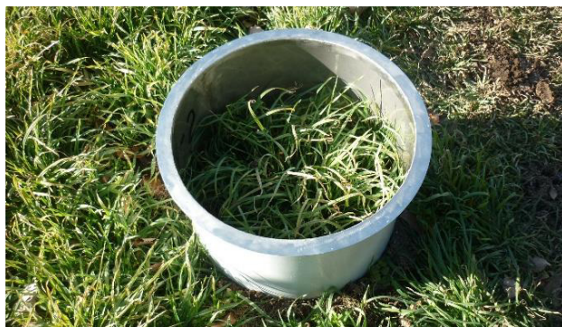
図 3 草地に設置されたチャンバーによる \text{N}_2\text{O} と \text{CH}_4 の発生量の測定
