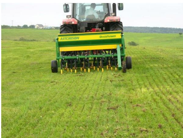
写真 作溝型播種機による草地更新
