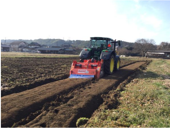
図5. ストーンクラッシャーによる礫破碎作業の様子
