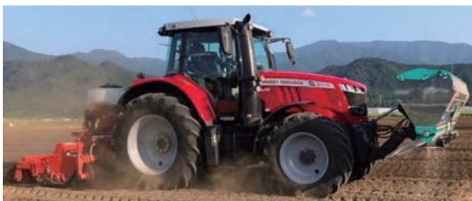
写真5 ドリルシーダ+パワーティラー+ライムソワ
