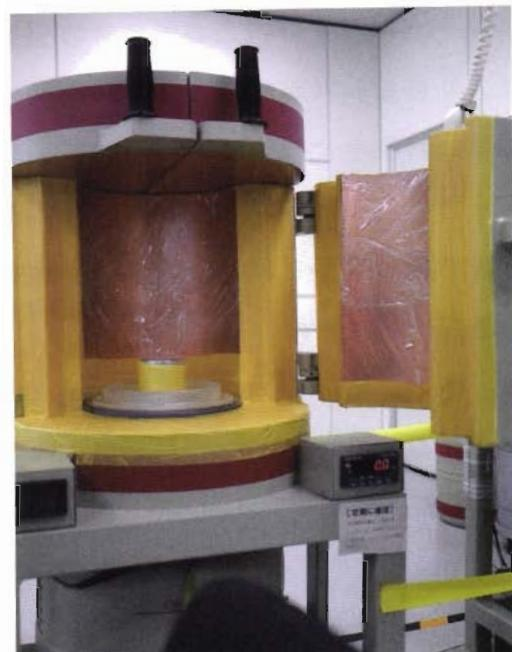
写真1 放射性物質濃度の精密測定に利用されるゲルマニウム半導体検出器
