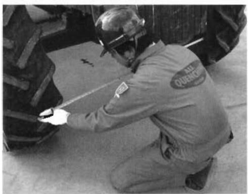
写真4 後輪内幅の計測
