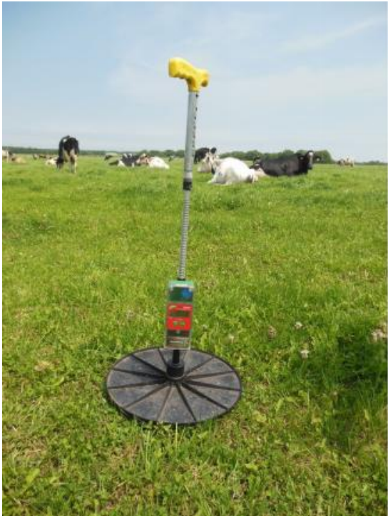
放牧地の草量を測るライジングプレートメーター
