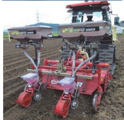
施肥ホoppaが増設された耕うん同時畝立て播種機写真は10L用ホoppa2個を増設した例
