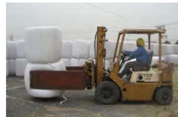
バールクランプでの保管作業
