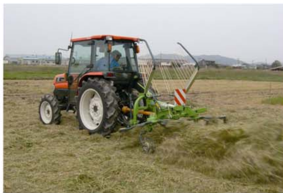
図2 ロータリテッダによる反転作業
