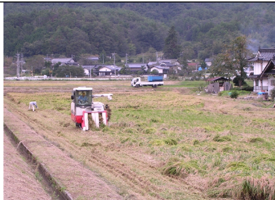
① 自脱型コンバインによる稲の刈り取り
