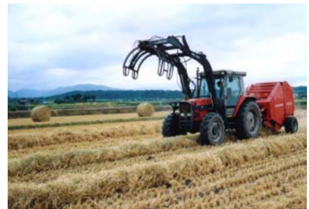
(搬出・積込は、トラクターの ロールグラブを使用)
