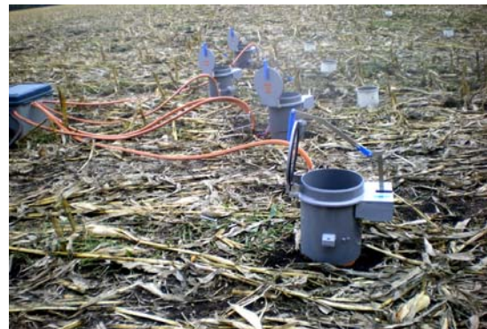
チャンパー法によるトウモロコシ畑の収穫後のCO 2 測定
