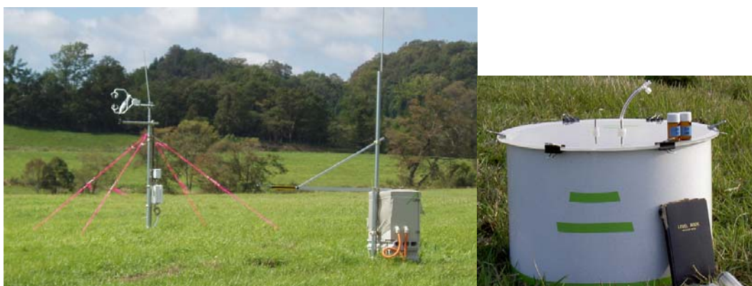
(写真) 渦相関法による二酸化炭素 (左) とチャンバー法によるメタンと亜酸化窒素ガス (右) の測定
