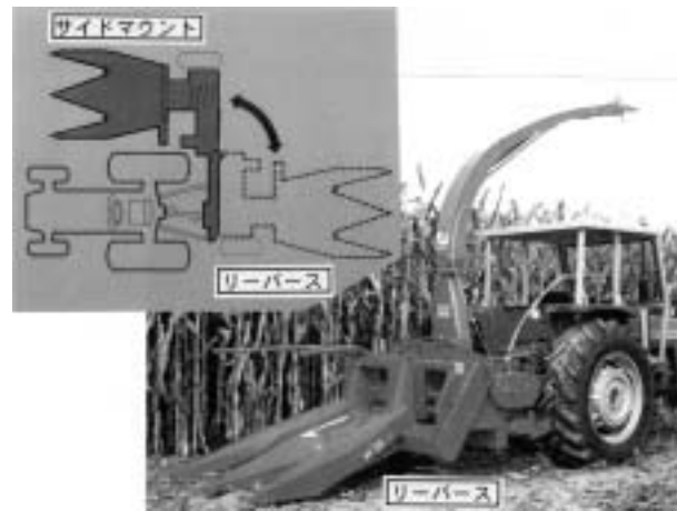
図4 サイドマウントとリバースタイプへの切り換え（FERABOLI社カタログに加筆）
