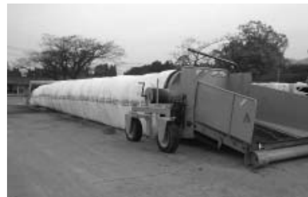
写真2 チューブバック詰込機
