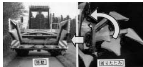
図6 アタッチメントの折り畳みと移動時の風景（CLAAS社カタログに加筆）
