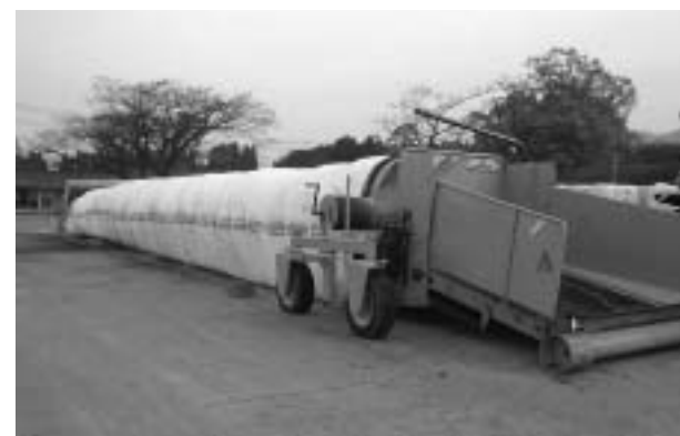
写真2 チューブバック詰込機
