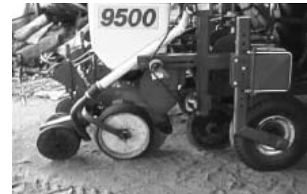
写真1 熊本県菊池地域で使用されている外国製の不耕起播種機(2条タイプ) (大村 誠:平成14年度九州地域飼料増産検討会・自給飼料生産新機械化体系シンポジウム資料)
