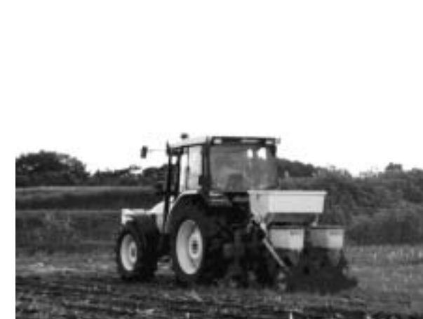
写真3 不耕起播種機による2期作目のは種
