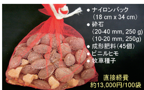
写真1 ストーンバックの作り方
