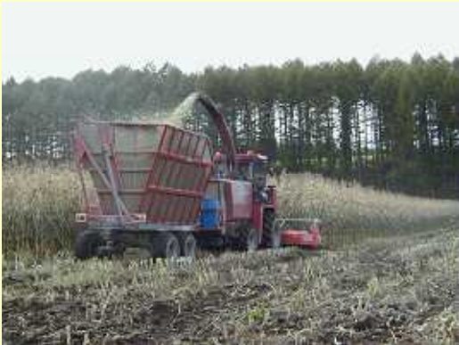
(写真:左)クラッシャー付き自走式ハーベスタによるトウモロコシの収穫風景
