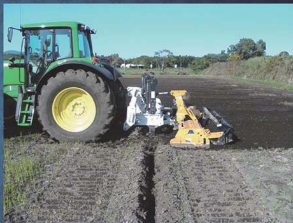
コンビソイラ (下層部を破碎し、心土や石礫を表面に あげる事なく、バーチカルハローで碎土・ 均平・鎮圧を同時に行う)
